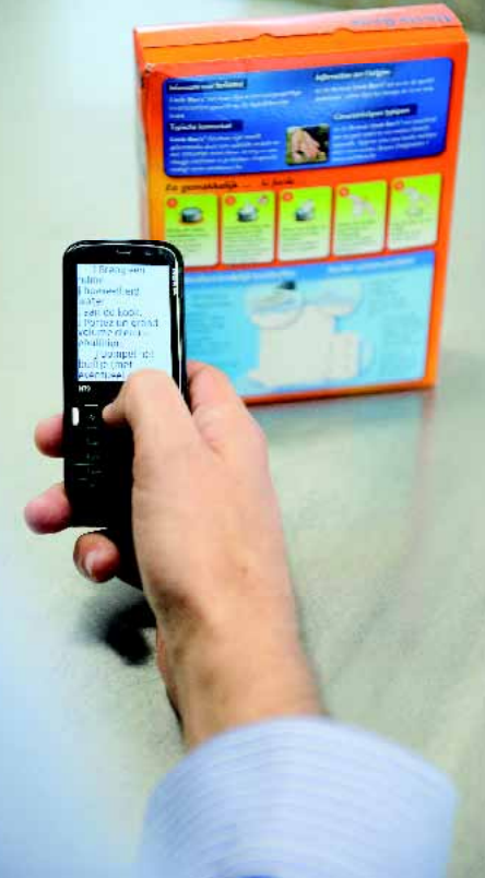
Met TextScout kan je een foto van een bedrukt vlak nemen en die laten omzetten in tekst.
