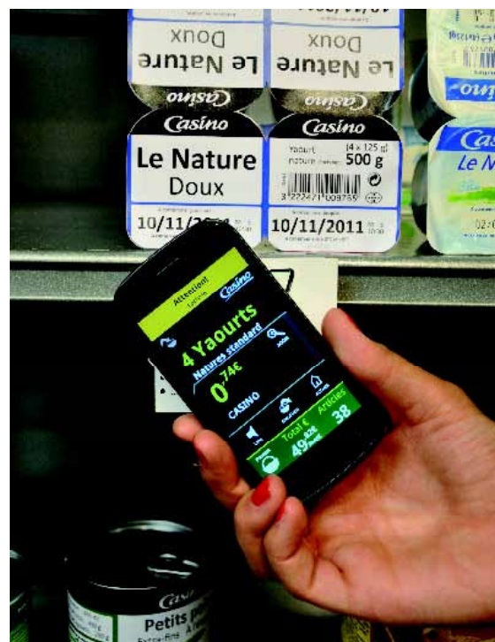
Casino test een gsm-applicatie die de klant toelaat om de informatie die vervat zit in een chip op het schaplabel weer te geven op zijn gsm.
